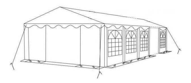
**Step1.** Assembly is easiest if you layout all parts on the ground as shown below. 2 meter per section 4x6m has 3 sections, Assemble the roof frame by mounting parts 4 and 5 on the pipes (parts 1, 2). Use the bolts(12) to attach the parts. Let op: *De stokken aangeduid met nr 1 zijn iets langer dan de No 2 stokken. 3 stikken met No 2 zijn ingekort!!*
